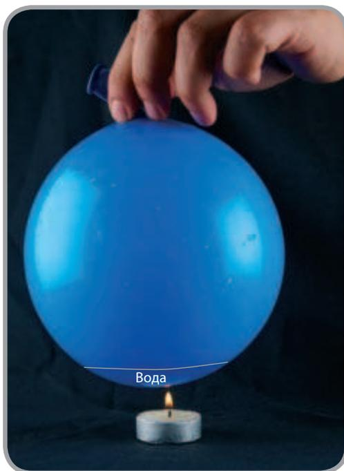
**Внимание!** Следи за тем, чтобы пламя свечи касалось только того места, где находится вода, иначе шарик лопнет!
